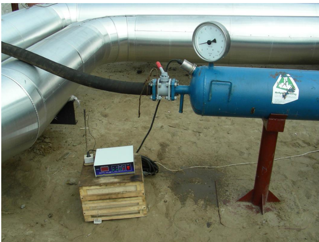
Рис. 7. Осветление подтоварной воды ультразвуком в сепараторе под давлением (ОАО «Сургутнефтегаз»)
