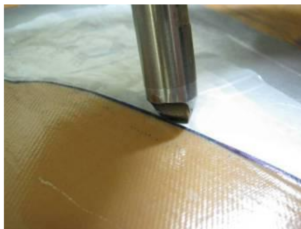
4) Перемещение УЗКС под наклоном для сварки
